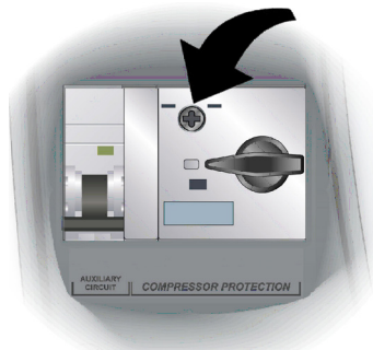
Rys 17. Do przeprowadzenia kalibracji należy użyć śruby regulacyjnej znajdującej się z przodu ochrony przeciążeniowej silnika.
