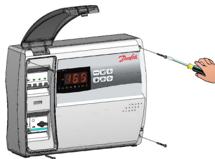
Rys 19. Dokręcić panel przedni używając do tego celu 4 śrub. Z prawej strony założyć osłonkę śrub.
